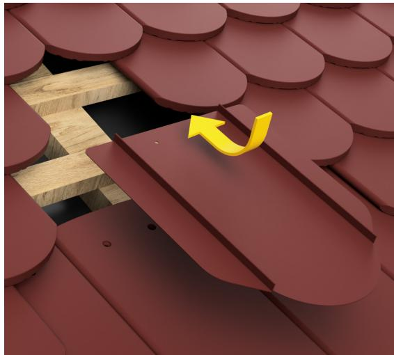
Zur Montage der Ersatzplatte müssen die umliegenden Dachziegel entfernt bzw. abgedeckt werden.
