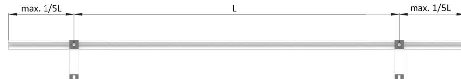
Der Überhang zum letzten Dachhaken an den Enden darf maximal 1/5 der Spannweite zwischen den Dachanbindungspunkten betragen.
