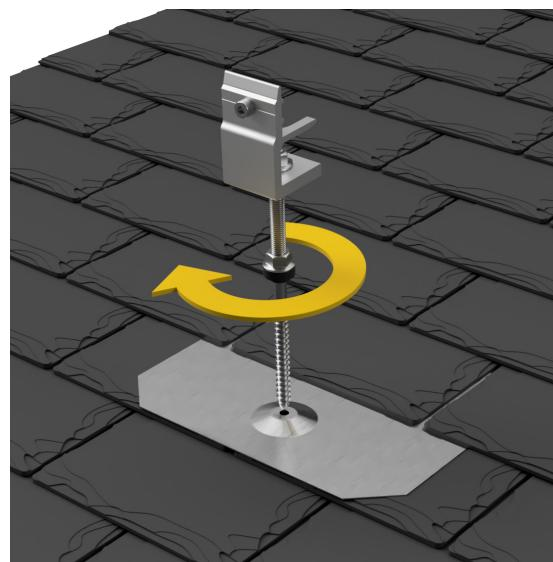
Die Stockschraube muss eingeschraubt werden, bis die EPDM-Dichtung auf der Dacheindeckung sitzt. Die EPDM-Dichtung muss mit einer Mutter befestigt werden. Das Metall darf dabei nicht eingedrückt werden.
