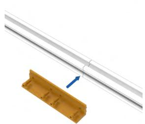
Optional: Zur Verbindung von Montageschienen muss ein fixer Schienenverbinder mit vier Schrauben montiert werden. Bis zu 18,6 m können so überbrückt werden.
