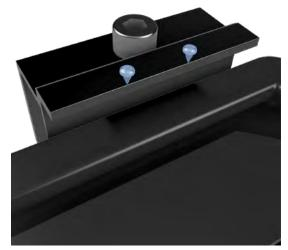
Die Klemmen sind zur Erdung von Modulfeldern mit Erdungspins ausgestattet, welche die eloxierte Schicht der Modulrahmen durchdringen. Die Erdung der Montage schienen kann mit der Erdungsklemme (SSFS1701) hergestellt werden.
