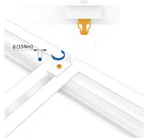
Anschließend werden diese mit einem Anzugsdrehmoment von 15Nm festgezogen.
