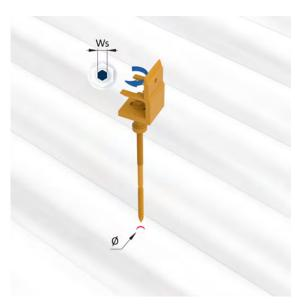
Die Dacheindeckung muss mit einem Durchmesser von 14 mm vorgebohrtwerden. Ebenso muss der Dachstuhl vorgebohrt werden (geeigneter Durchmesser M12: 8 mm, M10: 6.5 mm).
